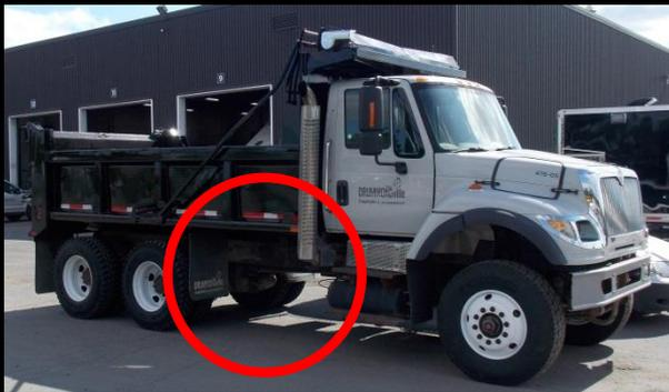
Dispositif physique qui comble l'espace vide entre la cabine et les roues arrière d'un véhicule afin d'éviter qu'un cycliste ou un piéton situé trop près du véhicule ne se retrouve sous les roues suite à une manœuvre de virage, ou ne se retrouve sous le véhicule en cas de chute.
